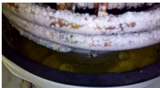
Gambar 4. Pembekuan PCM minyak kelapa pada dinding koil
