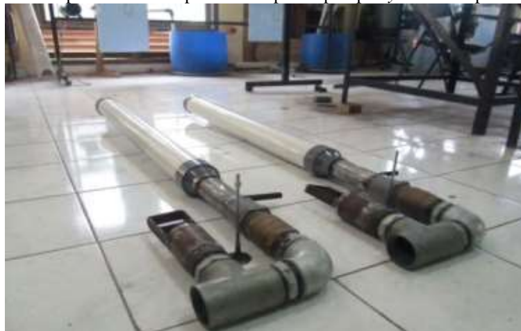
Gambar 4. Hasil pembuatan dan perakitan pompa hydrum
