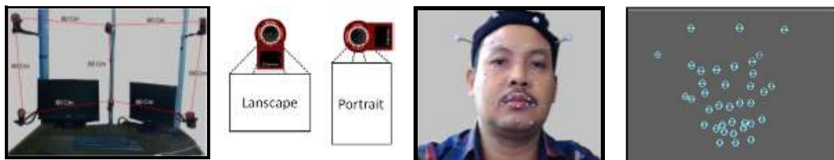
(a) (b) (c) (d) Gambar 2. Formasi Kamera (a), Kamera OptiTrack Tipe VR100:R2 (b), Pemasangan Marker di Wajah Aktor (c), Data MoCap Wajah (d)
