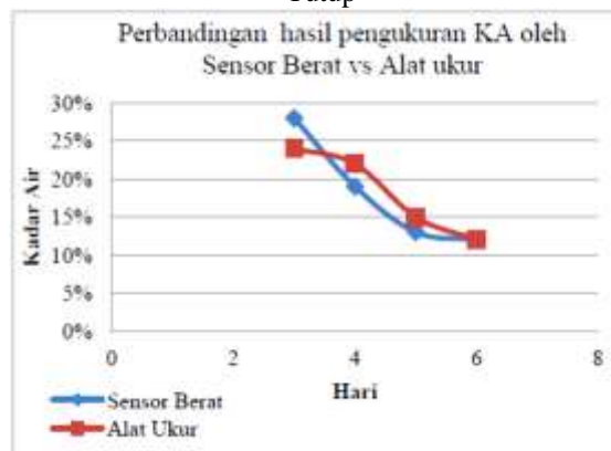
Gambar 3. Grafik Perbandingan Hasil Pengukuran KA oleh Sensor Berat dan Alat Ukur Pada Sistem Atap Bukaan Terbuka
