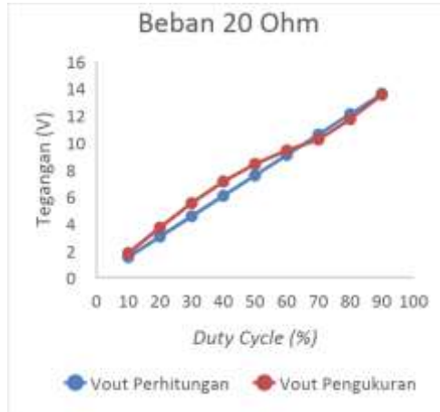
Gambar 4. Perbandingan nilai tegangan saat beban 20 ohm
