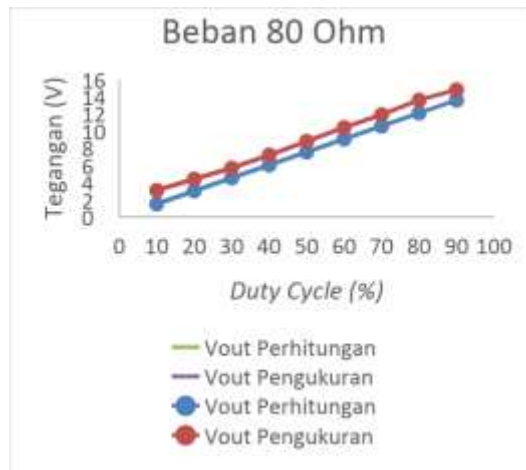
Gambar 5. Perbandingan nilai tegangan saat beban 80 ohm
